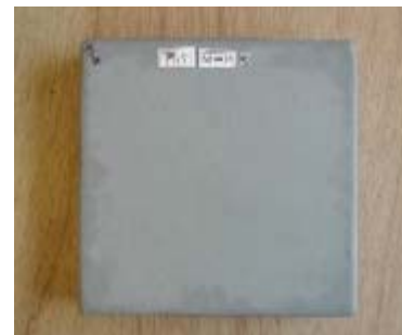
写真1 屋外暴露試験体 M-2-S-3 (M-2 宮古島 3年)
