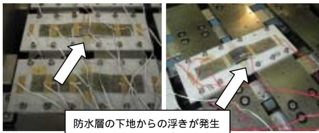
写真 - 3 浮き状況(密着仕様) 写真 - 4 浮き状況(緩衝テープ)
