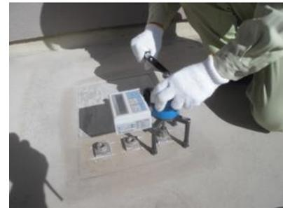
写真 1 付着強さ試験
